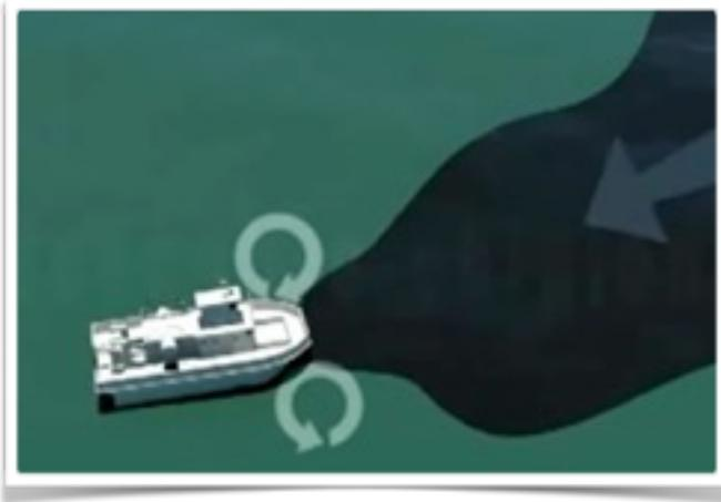
**OC-Tech** desarrolla una tecnología patentada que no solo innova el sector con un sistema recolector auto-gestionable, sino que en el caso de requerirlo, crea su propia corriente de aspiración y que, junto a una precisa maniobrabilidad, le permite dar respuesta de forma rápida y eficaz en tareas de limpieza, separando los sólidos de los líquidos y embolsándolos por separados en depósitos de polietileno, flexibles y flotantes.
